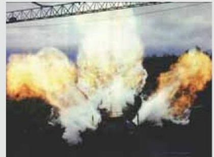
Prova di sfogo della pressione di esplosione in un recipiente da 250m 3 (Svizzera)
